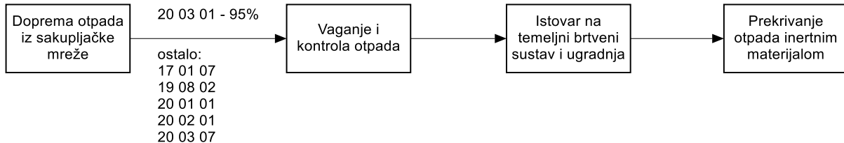
Slika 2.3.1.-1. Shematski prikaz tehnološkog procesa odlaganja
